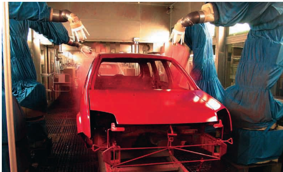
Cabine de aplicação de tinta por robô, na planta da Ford em Camaçari: altíssima tecnologia
